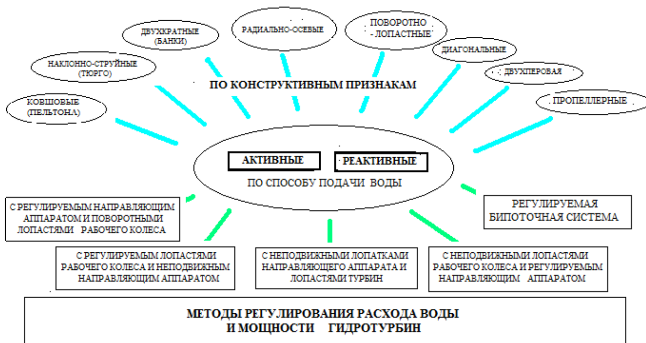
Рис. 1. Классификация активных и реактивных гидротурбин по конструктивному признаку и методу регулирования расхода воды и мощности гидротурбин
